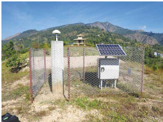
図3. Syanja観測点。左：GNSSアンテナとコンクリートピラー（地上高1.5m、深さ1.3m）、右：太陽電池パネルと機材収納ボックス（内部にGNSS受信機とバッテリーを収納）。
