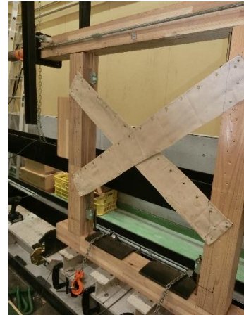
(b) 斜めに補強した布
