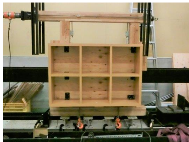
図4 手すりを耐震要素とした試験体
