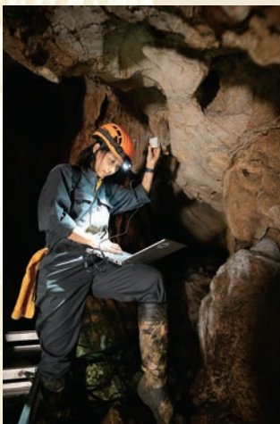
洞窟内に設置した温度計のデータを取り入れる作業
